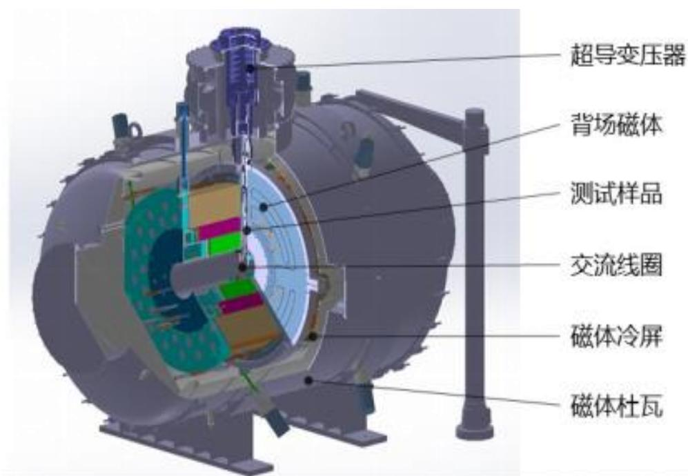
图 1 导体性能研究平台结构示意图
