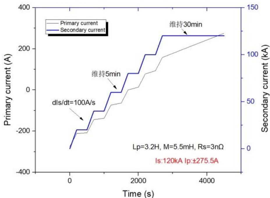
图 2 初级线圈运行波形
